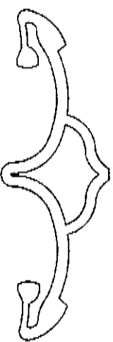
Rys. 9 – Wzmocniony profil uszczelniający stosowany w urządzeniach dylatacyjnych typu KP
